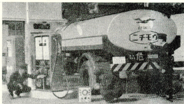
Inspectores revisando un coche tanque en una estación de servicio de gasolina. Están midiendo el grueso de la pared del tanque de gasolina por medio de un calibrador supersónico.
